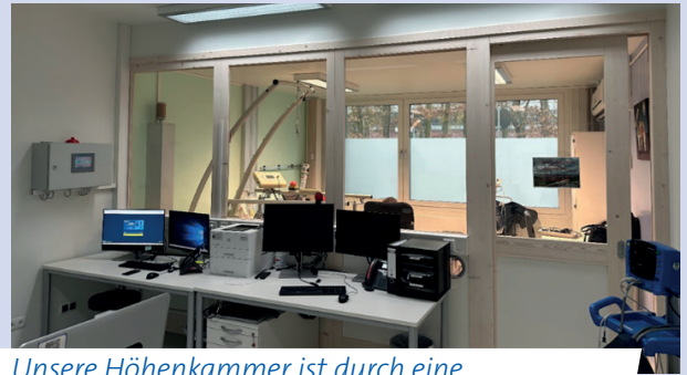
Unsere Höhenkammer ist durch eine Fensterscheibe vom Kontrollraum getrennt.
